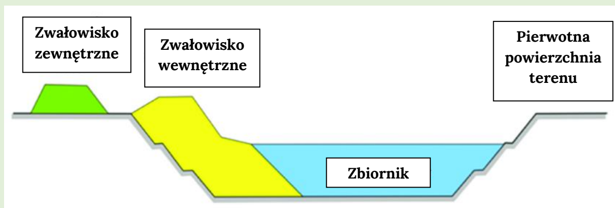
Rys. 3. Schemat typowego zbiornika powyrobiskowego 140 .
